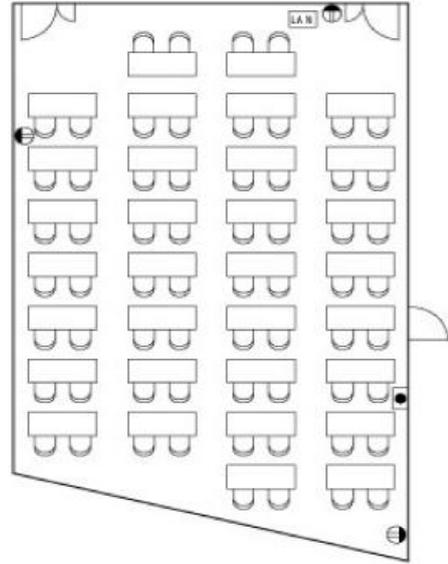
LAN : LAN 壁面取出し口    ● : コンセント    ● : 温度制御器
